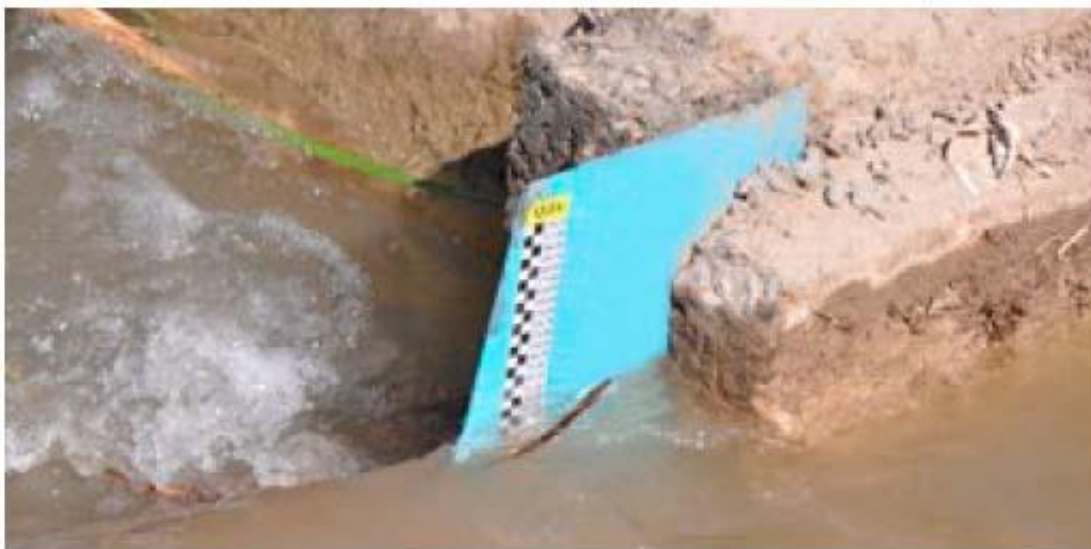
6-njy surat. Kämilleşdirilen suw ölçeyji enjamyň göçme bent gädigi.
